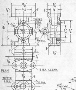
Fig. 37. Carburettor body
